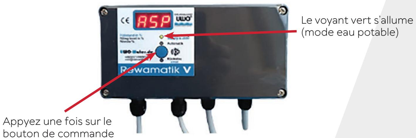
4. Un robinet doit être ouvert afin de purger la pompe et le réseau. Si le système de contrôle émet un message d'erreur et que la pompe s'arrête, remplissez la pompe d'eau et appuyez sur le bouton de réinitialisation. Répétez cette opération plusieurs fois si nécessaire.
