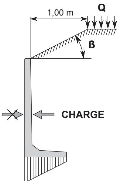
**Exemple :** Pour un mur haut. 1,25 m (trait gris sur le schéma ci-dessus), la charge maxi donnée sur remblai est de 1,75 t/m<sup>2</sup>. L'angle du talu  $\beta$  maxi. est donc = 20°
