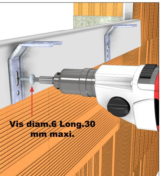
Présenter l'équerre et s'assurer qu'un trou se trouve bien entre 50 et 70 mm par rapport au haut de l'appui. Frapper la vis au marteau afin de casser le voile de béton de 4 mm. Vous pouvez dès à présent finir de fixer l'équerre à l'aide d'une visseuse/dévisseuse. Pour ce faire, utiliser une vis spéciale penture bois à tête bombée Torx diam.6 Long.30 mm maxi (vis non fournies).
