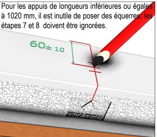
Les inserts polystyrènes sont marqués de repères carrés avec une flèche à l'intérieur. Ces repères permettent de trouver l'emplacement aléatoire des chevilles intégrées dans le produit. Marquer l'emplacement de la cheville dans le prolongement de la flèche. Le tracé devra se situer entre 50 et 70 mm par rapport au haut de l'appui.
