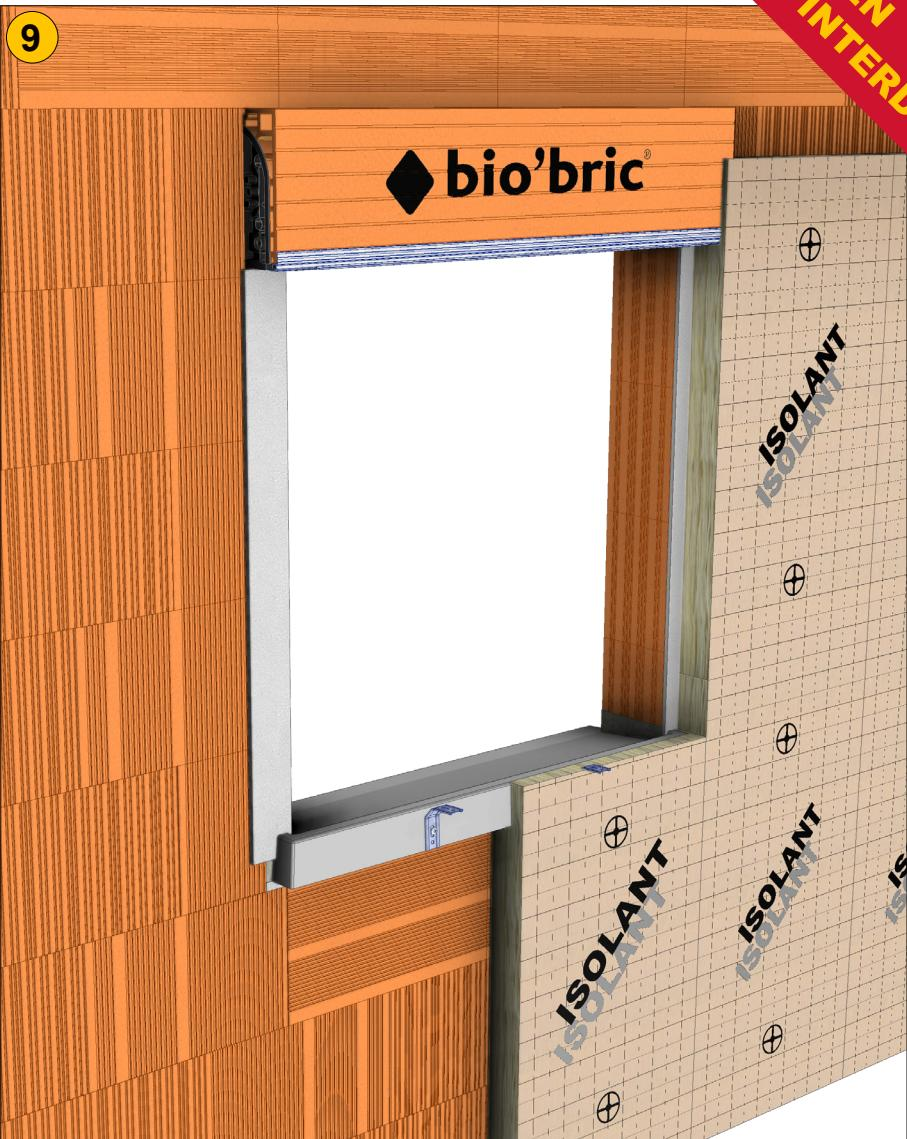
Assurez vous que l'étanchéité périphérique de la menuiserie est parfaite. Si nécessaire, charger en silicon les deux angles inférieurs des menuiseries, poser l'isolation etc...
