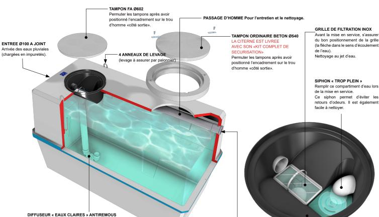
SORTIE EXCENTREE Ø100 A JOINT Evacuation des eaux chargées en impuretés vers l'exutoire. (Prévoir un système anti rongeurs + clapet anti-retour si besoin).
