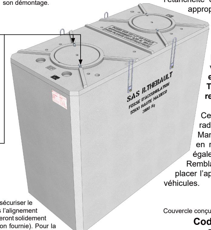
A la mise en service, ne pas oublier de sécuriser le tampon en positionnant les pattes dans l'alignement des encoches du tampon. Les 2 pattes seront solidement serrées à l'aide d'une clé BTR de 6 (non fournie). Pour la sécurisation du tampon sur rehausse, consulter la fiche du Kit de sécurisation, code : 110399.
