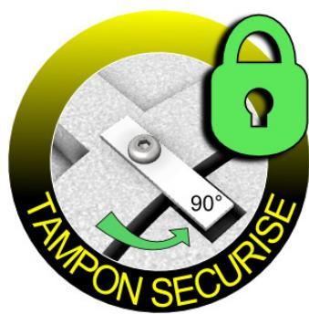
A la mise en service, ne pas oublier de sécuriser le tampon en positionnant les pattes dans l'alignement des encoches du tampon. Les 2 pattes seront solidement serrées à l'aide d'une clé BTR de 6 (non fournie). Pour la sécurisation du tampon sur rehausse, consulter la fiche du Kit de sécurisation, code : 110399.
