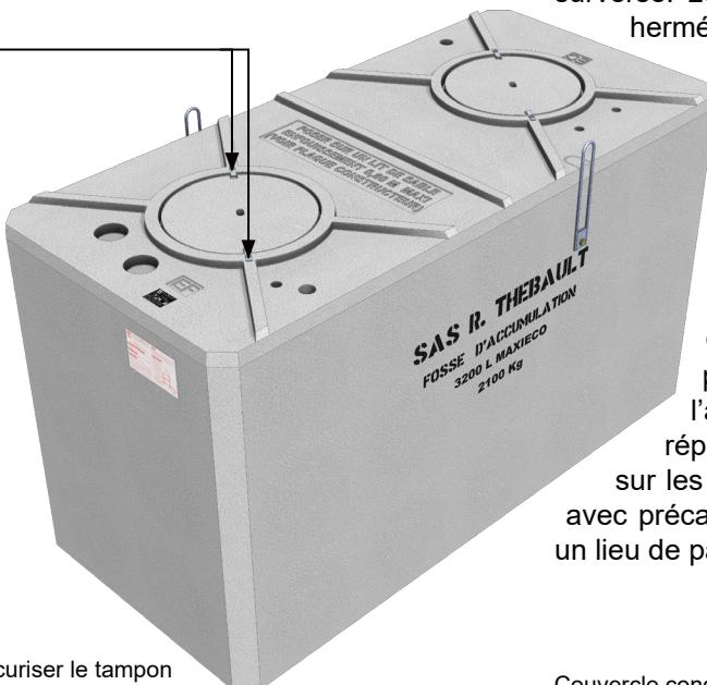
Appareil conçu pour un enfouissement jusqu'à 0,80 m. En cas de pose de rehausse, assurer l'étanchéité des joints au moyen d'un produit approprié, pour éviter les rentrées d'eau en surverse. Le poseur devra rendre les tampons hermétiques.
