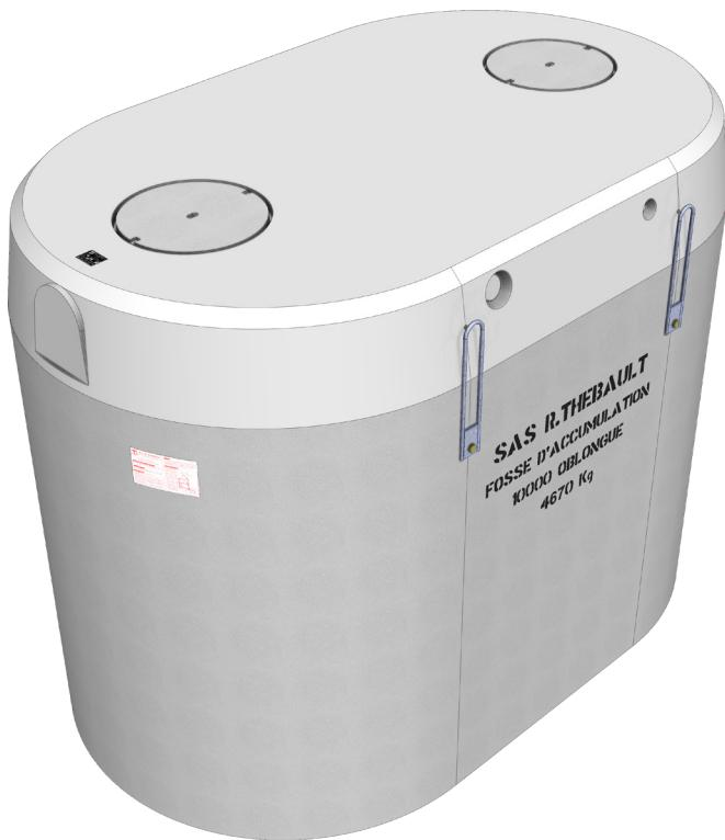
Appareil conçu pour un enfouissement jusqu'à 0,80 m. En cas de pose de rehausses, assurer l'étanchéité des joints au moyen d'un produit approprié, pour éviter les rentrées d'eau en surverse. Le poseur devra rendre les tampons hermétiques.
