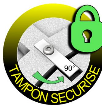
A la mise en service, ne pas oublier de sécuriser le tampon en positionnant les pattes dans l'alignement des encoches du tampon. Les 2 pattes seront solidement serrées à l'aide d'une clé BTR de 6 (non fournie). Pour la sécurisation du tampon sur rehausse, consulter la fiche du Kit de sécurisation, code : 110399.
