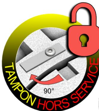
A la livraison, le tampon est non sécurisé (les 2 pattes ne sont pas dans l'alignement des encoches du tampon) afin de faciliter son démontage.
