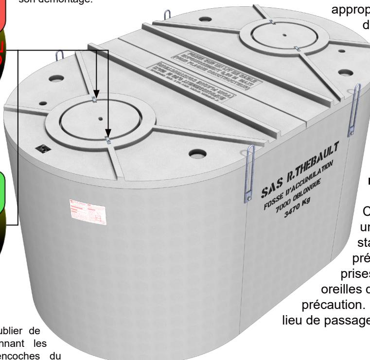
Appareil conçu pour un enfouissement jusqu'à 0,80 m. En cas de pose de rehausses, assurer l'étanchéité des joints au moyen d'un produit approprié, pour éviter les rentrées d'eau en surverse. Le poseur devra rendre les tampons hermétiques.
