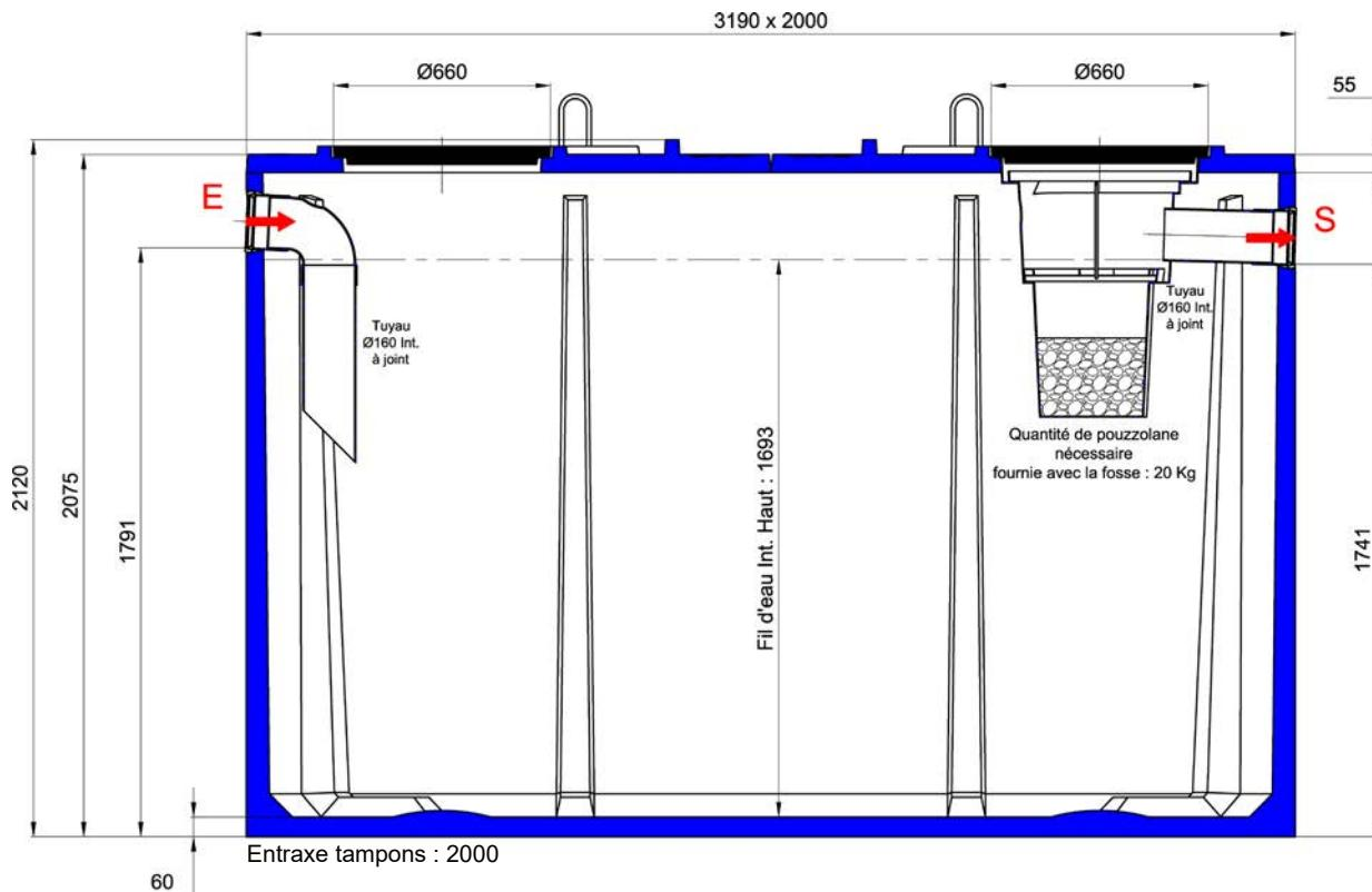
\* R.A.C. : Renforcement anti-corrosion par traitement spécifique du béton sur les parties non immergées de la fosse ainsi que sur les tampons (Code Tampon R.A.C. : 150361 - Poids : 32 Kg). Cependant, la pose de la ventilation doit se faire conformément au DTU 64.1
