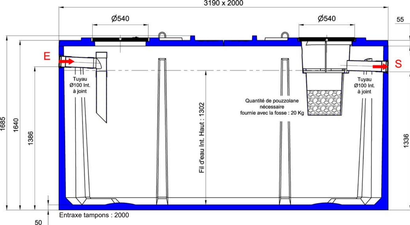
\* R.A.C. : Renforcement anti-corrosion par traitement spécifique du béton sur les parties non immergées de la fosse ainsi que sur les rehausse et tampons. Cependant, la pose de la ventilation doit se faire conformément au DTU 64.1
