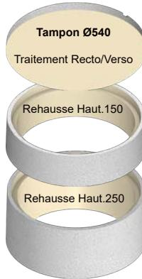
A la mise en service, ne pas oublier de sécuriser le tampon en positionnant les pattes dans l'alignement des encoches du tampon. Les 2 pattes seront solidement serrées à l'aide d'une clé BTR de 6 (non fournie). Pour la sécurisation du tampon sur rehausse, consulter la fiche du Kit de sécurisation, code : 110399.
