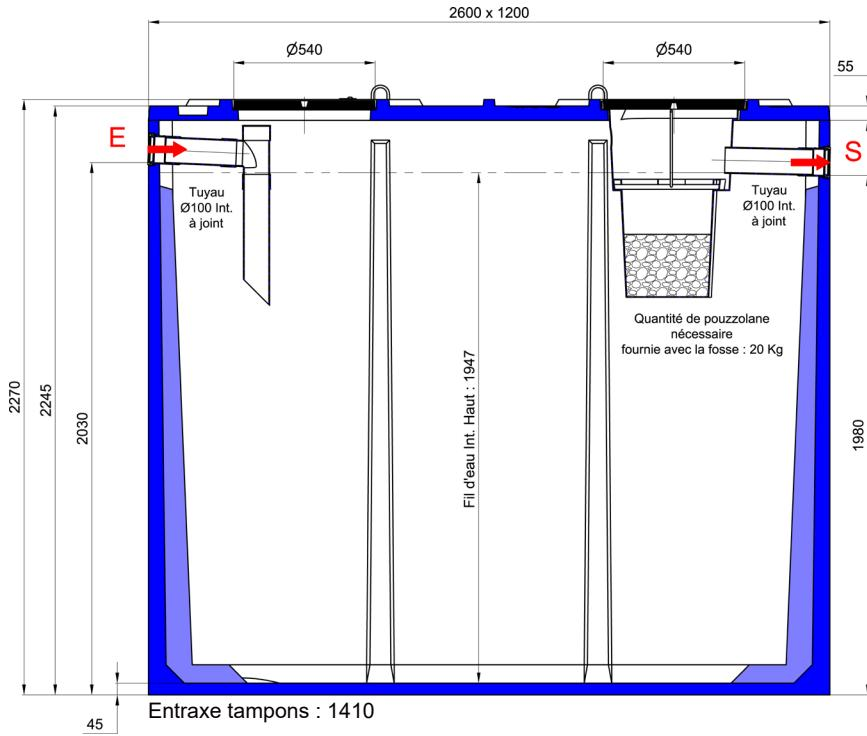
\* R.A.C. : Renforcement anti-corrosion par traitement spécifique du béton sur les parties non immergées de la fosse ainsi que sur les rehausse et tampons. Cependant, la pose de la ventilation doit se faire conformément au DTU 64.1
