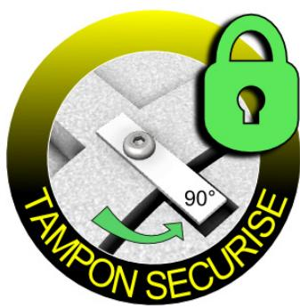
A la livraison, le tampon est non sécurisé (les 2 pattes ne sont pas dans l'alignement des encoches du tampon) afin de faciliter son démontage.
