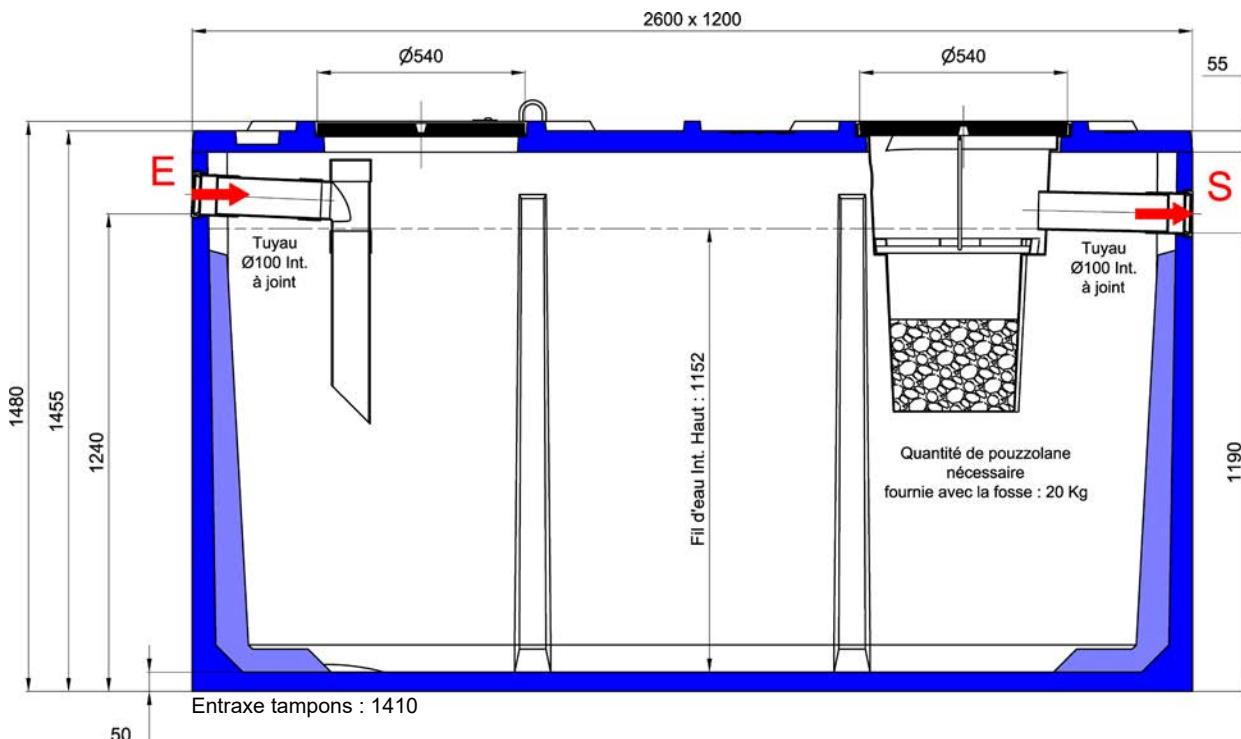
\* R.A.C. : Renforcement anti-corrosion par traitement spécifique du béton sur les parties non immergées de la fosse ainsi que sur les rehausses et tampons. Cependant, la pose de la ventilation doit se faire conformément au DTU 64.1
